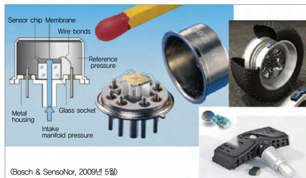
【그림 9】 실리콘 압력 센서 및 TPMS 응용
