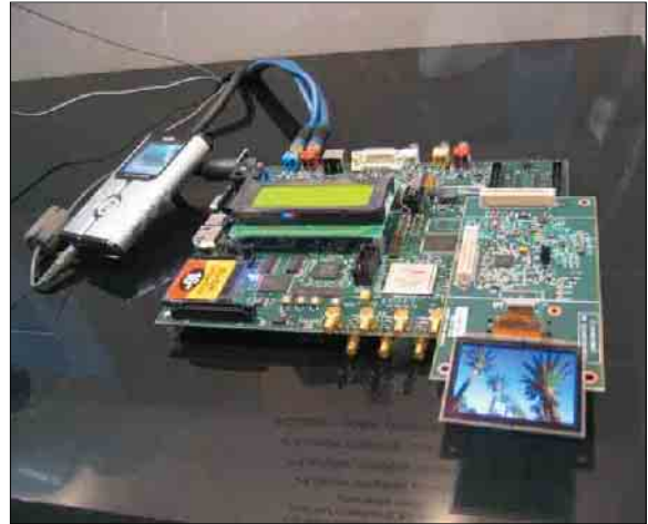
사진 4. Kodak의 OLED를 이용한 소형 디스플레이(PMP) 모듈
