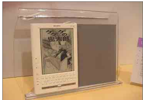
그림 4. E-Ink의 마이크로캡슐형 전기영동 디스플레이 필름을 이용하여 필립스 전기의 a-Si 구동기판을 조합시킨 소니의 LIBRIe 전자 reader
