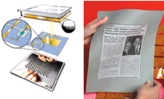
〈그림 13〉 Plastic Logic社 E-paper의 모식도(좌)와 제품(우)
