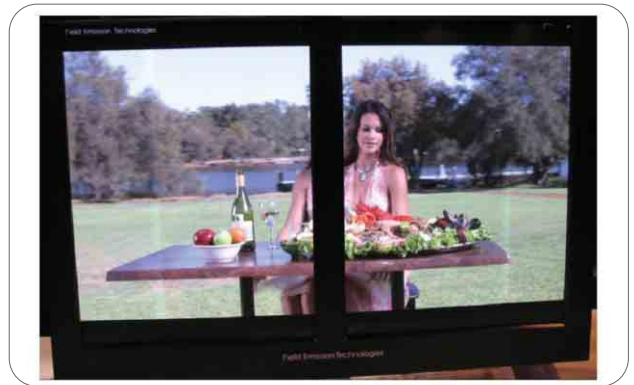
그림 9. 26인치 Diagonal Full-HD FED 1920×1080 (Field Emission Technologies Inc.)
