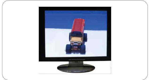
그림 8. 19.2인치 나노 스피트 FED (Field Emission Technologies Inc.)
