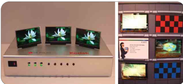
그림 7. LPL 3인치 AM-OLED와 CDT의 프린팅 공정 적용 AM-POLED
