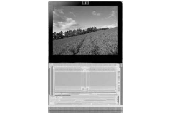
그림 14. NEC의 D램이 내장된 1.1인치 160×120 해상도 LCD [EE TIMES, 2007,5]
