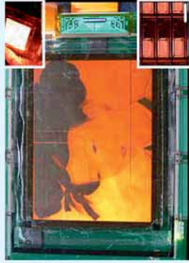
〈그림 7〉 Si TFT backplane를 이용한 4인치 crosslinked QD-LED (500 cd/m 2 의 밝기로 빛을 내는 1 Pixel (무색 상단), 각각의 pixel 원색 바의 길이는 100 μm (무색 하단))
