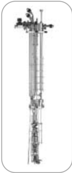
그림 10. Dilution refrigerator (모델명:KelvinoxMX)
