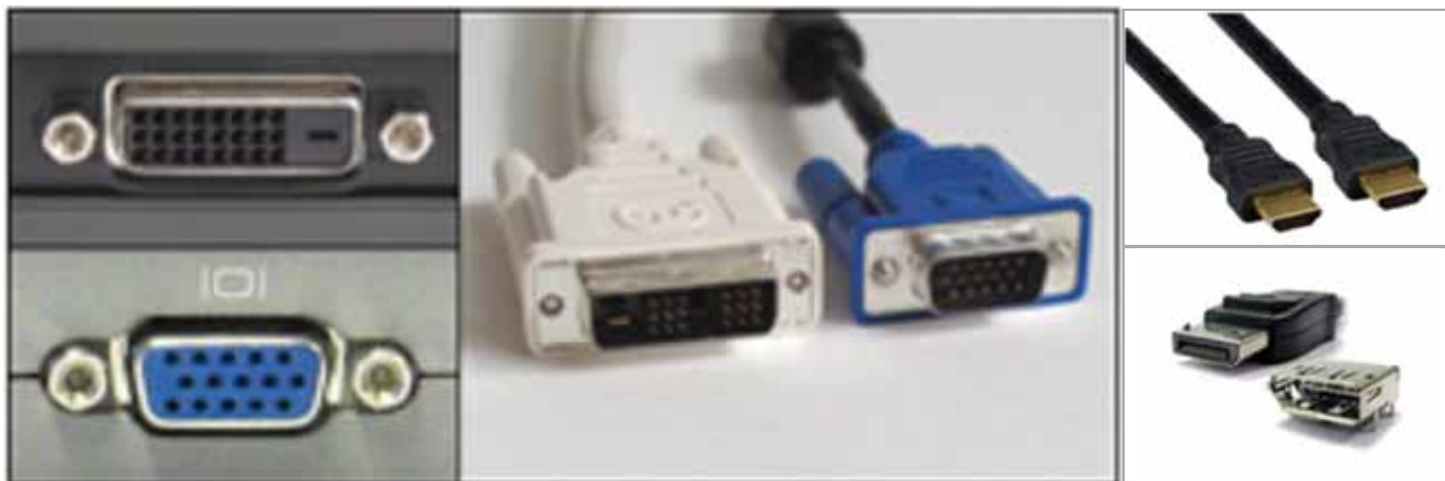
〈그림 9〉 디스플레이 연결 Connector 비교(DVI, D-SUB, HDMI, Display Port)
